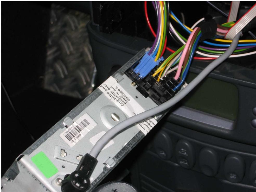
Mit dem iceLink verbinden - Stecker ganz rechts in die Buchse.
