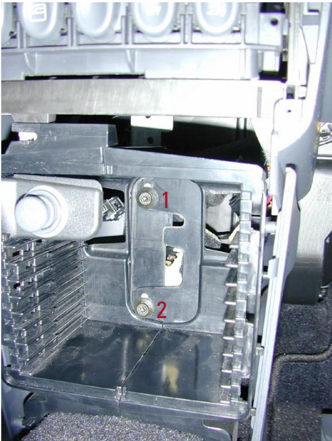
Zwei Schrauben im Schubladenschacht entfernen (1+2; Torx 27).
