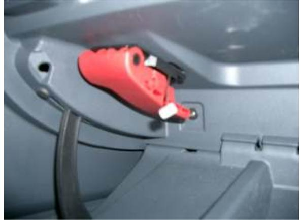
Die Halterung (kurzes Ende) wurde mittels einer Blechmutter am unteren Ende des Haubenschloss befestigt. (Die Schraube wurde noch nicht ganz festgezogen.) Dann wurde der Stellmotor wie dargestellt ebenfalls an der Halterung festgeschraubt.
