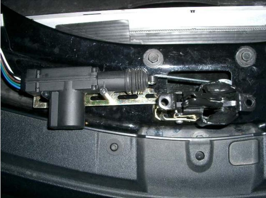
Die Haubenentriegelung wurde wie dargestellt durch die Öffnung geschoben. Der Stellmotor wurde vorher mit dem Leitungsstrang verbunden.
