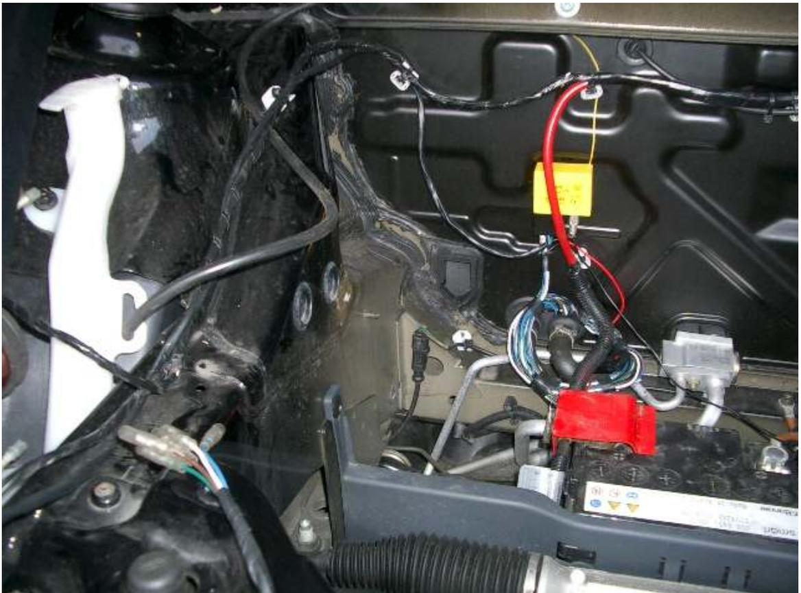
Die Zuleitung zum Stellmotor habe ich entlang eines vorhandenen Kabelbaums zur Haubenentriegelung geführt.
