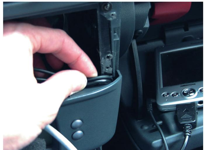
Nach dem Herausschieben muss nun das Kabel möglichst elegant zur Y-Kupplung im Radioschacht verlegt werden. Bei dieser Gelegenheit fädeln wird das Ende des selbst gefertigten neuen Anschlusskabels mit dem 2,5 mm Klinkenstecker zum PDA gleich mit durch. Beide Kabel laufen später rechts unter dem Radio vorbei hinter den BC.
