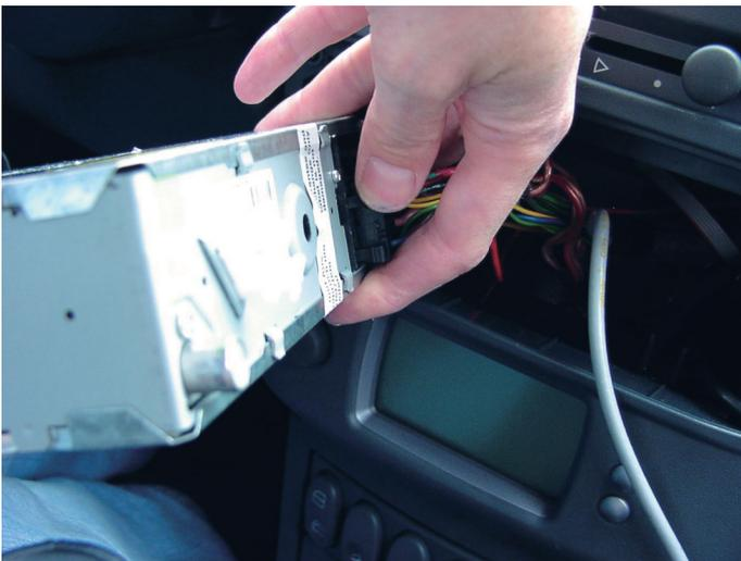
Bitte nun die Platzverhältnisse hinter bzw. unter dem Radio prüfen. Bei Roadstern mit Bordcomputer ist hinter diesem sehr viel teure Luft mit viel Platz für die zusätzlich Zigarettenanzünder-Buchse und die Mute-Schaltung vorhanden. Zur weiteren Montage nun den Bordcomputer ausbauen. Dieser ist, wie scheinbar alle Teiles des Roadsters, mit Plastiknasen befestigt. Ein leichter Fingerdruck an der richtigen Stelle und der BC lässt sich spielend leicht nach vorn heraus schieben.
