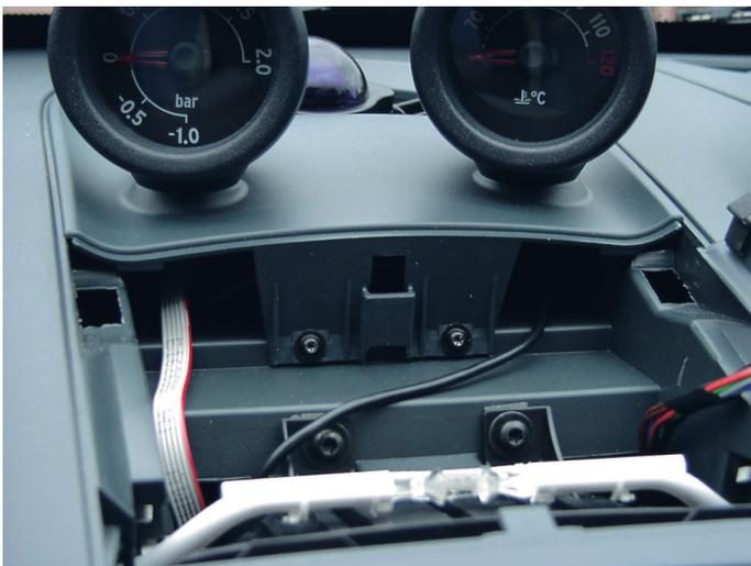
Wenn das Ende des GPS-Maus Kabels im Radioschacht an der Y-Kupplung des Navi-Kabels angeschlossen ist ist auch dieser Teil der Montage abgeschlossen.
