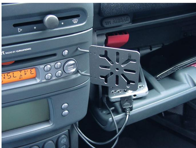
Auf der Lochplatte des Handyhalters lässt sich die mitgelieferte Platte des PDAs (vom Schwanenhals) recht einfach anschrauben. Will man die Platte beliebig verstellen, ist noch eine Kugelgelenkplatte (Handyzubehör) zwischen Hama-Halter und PDA Halter zu montieren. Nun sollte sich der PDA fest und gut sichtbar neben dem Radio befinden.
