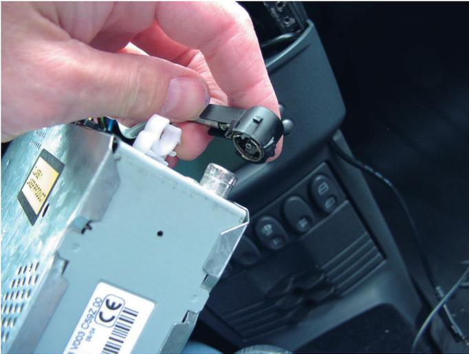
Dabei Kollisionen mit Schaltknauf und Lenkrad vermeiden. Den Antennenanschluss abziehen und die DIN-Stecker hinten mit Druck auf die Verriegelungsfedern heraus ziehen. Das Radio nun sicher beiseite legen. Besitzer von geklauten Autos und unordentliche Naturen haben nun bereits das erste Problem. Zum späteren Wiedereinbau des Radios muss natürlich der Code eingegeben werden.
