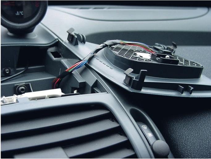
Die Schalter sind mit einem codierten Flachstecker angesteckt. Die Platte lässt sich auch angeklemt zur Seite legen. Nun den GPS Empfänger z.B. mit dem beiliegenden Klettband befestigen. Möglichst freie Sicht nach oben sollte er natürlich haben.
