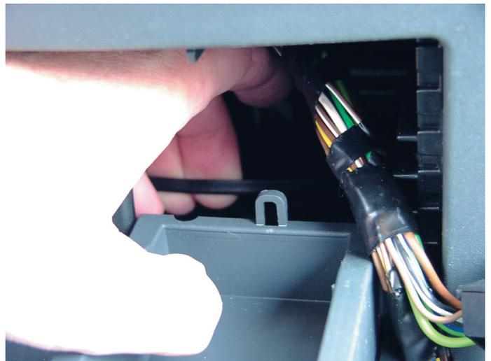
Dies funktioniert im Prinzip bei Ascher und CD Haltern identisch. Mit ein wenig Geschick lassen sich alle Teile ohne Kratzer vor der Schaltkonsole hochfädeln. Nun verbleibt nur noch der Zigarettenanzünder seitlich links verschraubt im Schacht. Mit einem kleinen Torx-Schraubendreher lässt er sich abschrauben. Mit etwas Glück funktioniert der nächste Schritt aber auch bei eingebauter Buchse.
