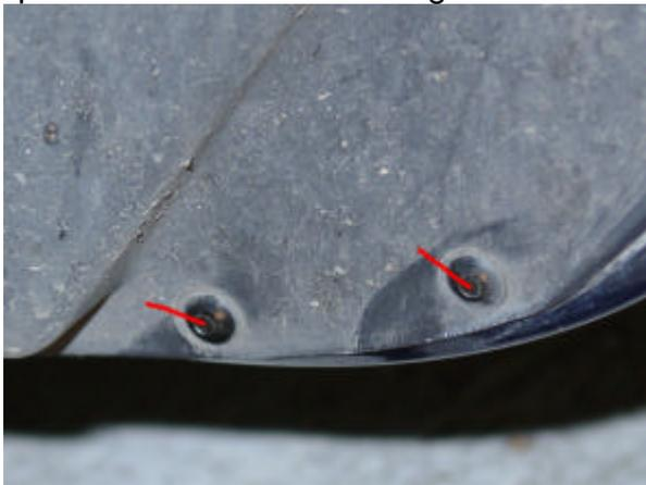
7. Am hinteren Ende des Radkastens ist von unten noch je eine Spreitzniete die auch entfernt werden muss.
