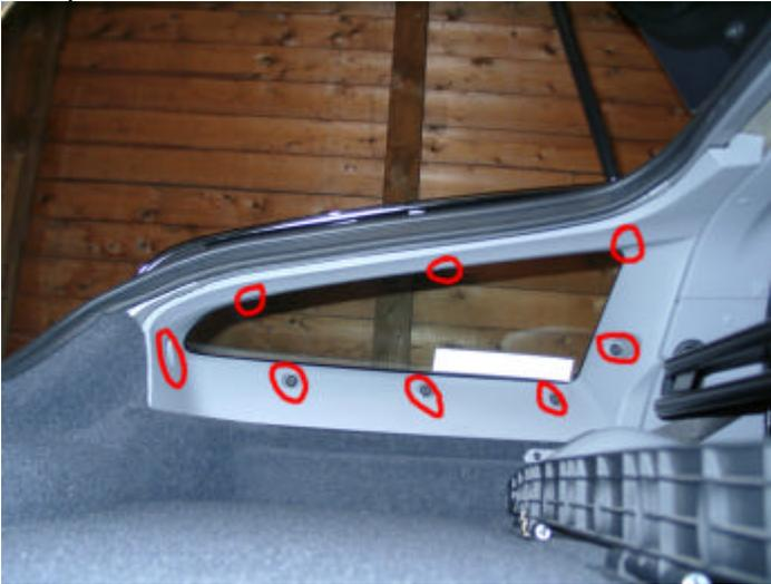
2. 20 große Schrauben wie auf den Bildern zu sehen entfernen. Jeweils drei seitlich vom Kofferraum, je zwei an der Tridion, je zwei unter der Kappe für den Wagenheber, zwei an den angedeuteten Gittern am Heck, vier am Heck zwischen den Rücklichtern, beim Coupe muss dafür die Dichtung abgezogen und die Gummistopfen entfernt werden.
