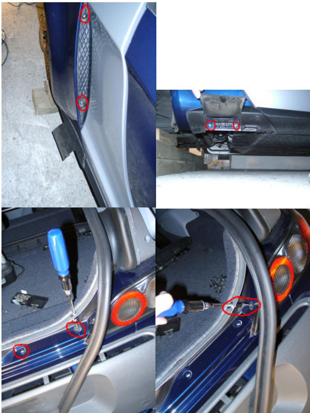
3. mit einem Torx 20 die Lampeneinheiten lösen. Kurze Schrauben
