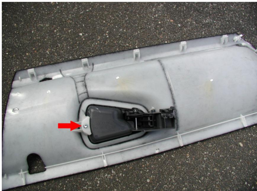
Nach Entfernen der Torx Schraube (TX20) kann der Türöffner leicht von der Verkleidung gelöst werden (herausdrehen)
