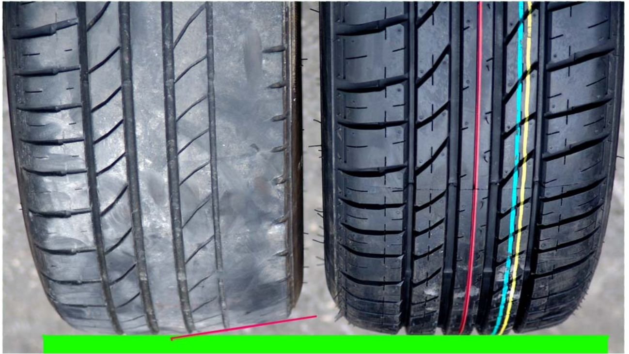
Asymmetrisch abgefahrener Vorderreifen und neues Exemplar daneben.
