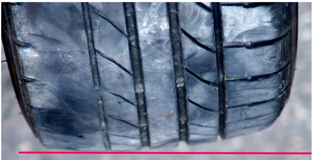
Vorderreifen mit deutlich asymmetrischem Abrieb bei 2,0 – 2,3 bar
